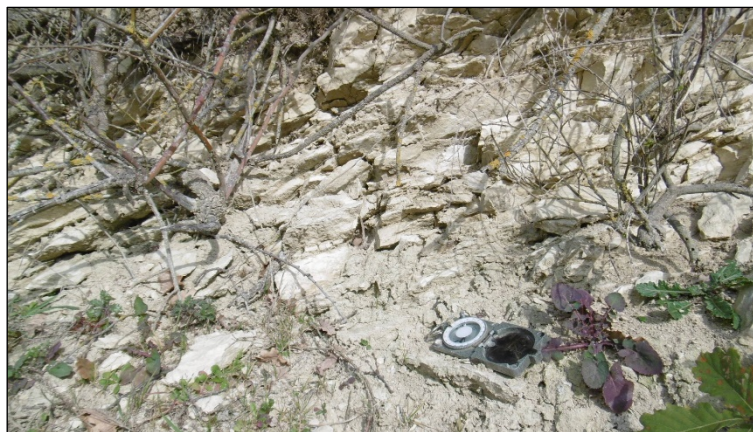
Foto A - Formazione dello Schlier , marnoso-calcareo, in strati sottili, affiorante a sud-ovest del nucleo storico di Pagliano
